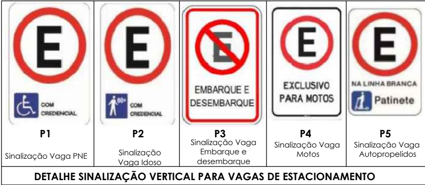
DETALHE SINALIZAÇÃO VERTICAL PARA VAGAS DE ESTACIONAMENTO
