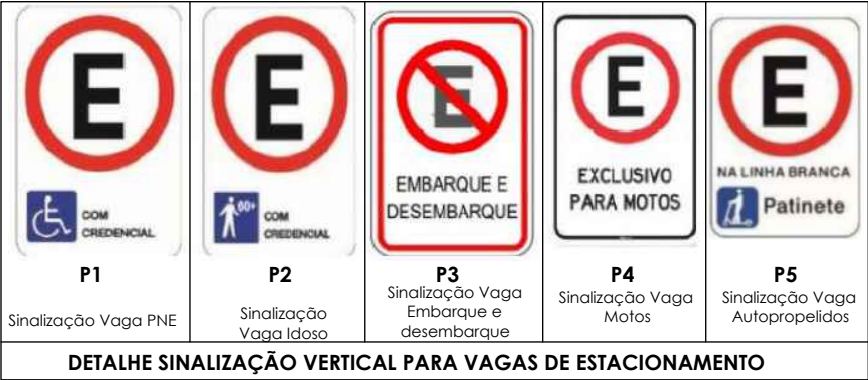
DETALHE SINALIZAÇÃO VERTICAL PARA VAGAS DE ESTACIONAMENTO
