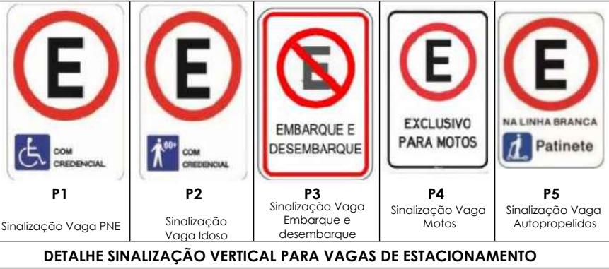
DETALHE SINALIZAÇÃO VERTICAL PARA VAGAS DE ESTACIONAMENTO
